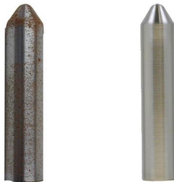
Imagen 1: estado del inyector sin utilizar aditivo (izquierda) y estado del inyector con 500 ppmv equivalente del Fuel Saver - MT 177 (derecha)
